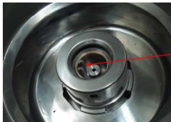
Grease cup: Bowl 회전 시 원활 Grease 주입장치
